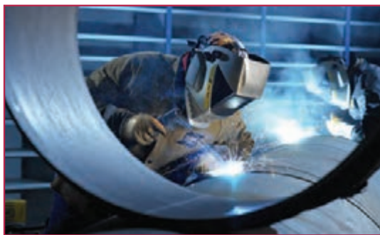
شکل ۵-۱- جوش کاری مخزن فولادی
